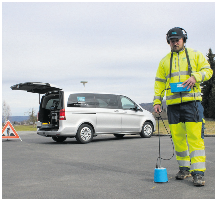
Sven Ramseier bei der Arbeit: Mittels Bodenmikrofon ortet er eine undichte Stelle im Wasserleitungsnetz. Foto Pascal Vogel
